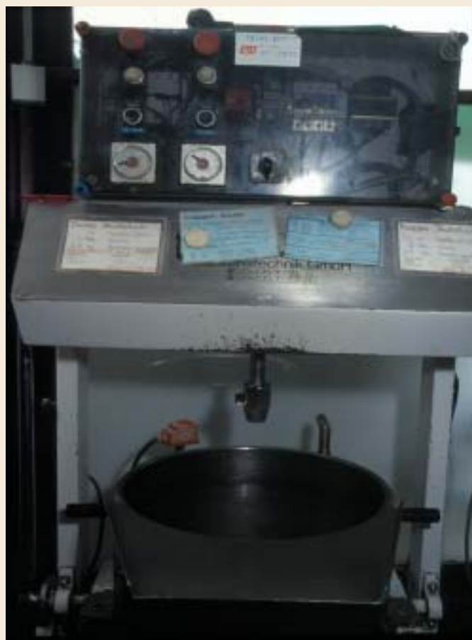
Bei Schubert zuständig für die Brotfrischhaltung: Die Anlage zur Herstellung von Brühstücken.
