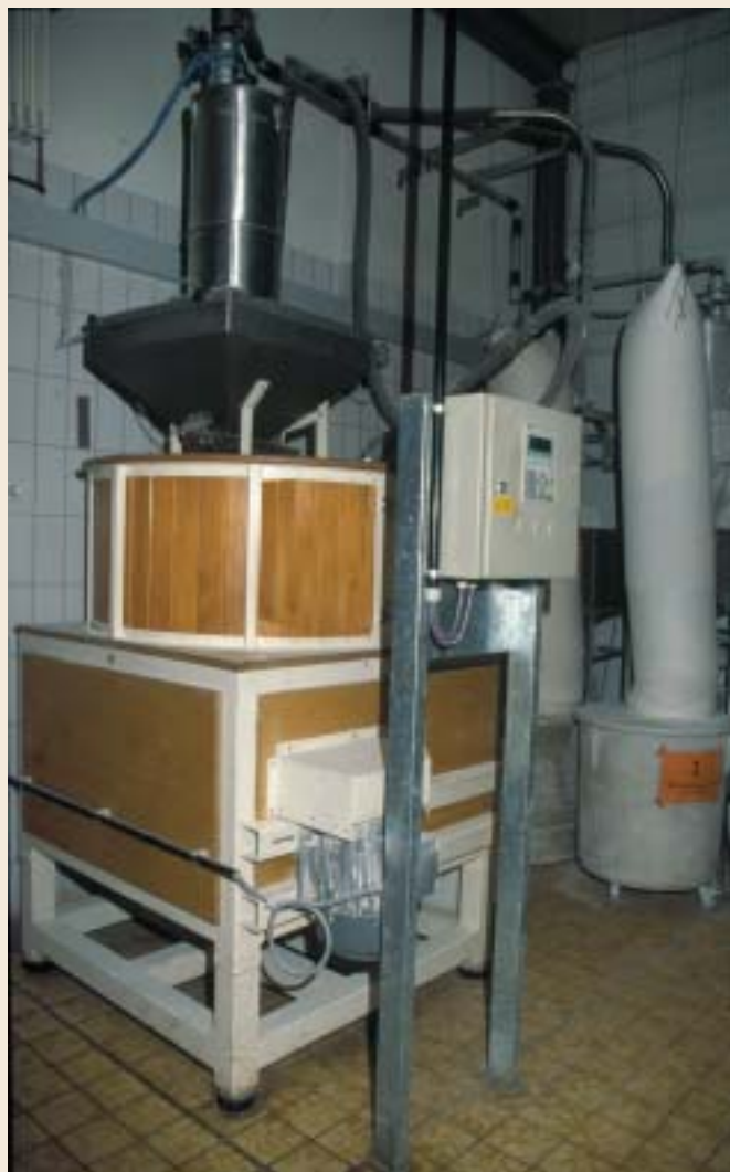
Eine sinnvolle Kombination: Osttiroler Steinmühle für Vollkornbrot und Zentrofan-Mühle (im Hintergrund) für Feingebäck.
