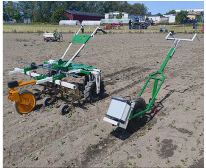
Abb. 2: Prototyp der Dreiradhacke (links) und der Einradhacke (rechts)
