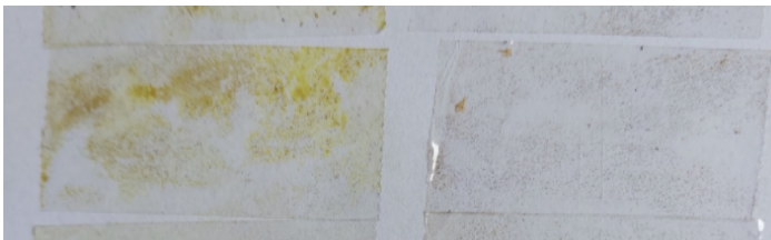
Abb. 3: Klebestreifen ohne TRM (links – gelb) und mit TRM (rechts – grau)
